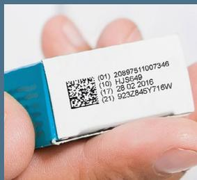
Continuous Ink Jet-Drucker (CIJ) bieten als flexible Lösung die Möglichkeit, bis zu 5 Zeilen Text sowie zweidimensionale und lineare Barcodes auf einer Vielzahl von Verpackungsarten zu drucken. Thermotransfersysteme (TTO) empfehlen sich für den hochauflösenden Druck auf flexiblen Verpackungsfolien.
